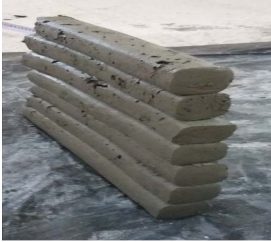
Şekil 6. Uygun Beton Harcın Pompa Ağzından Çıkış Görüntüsü
