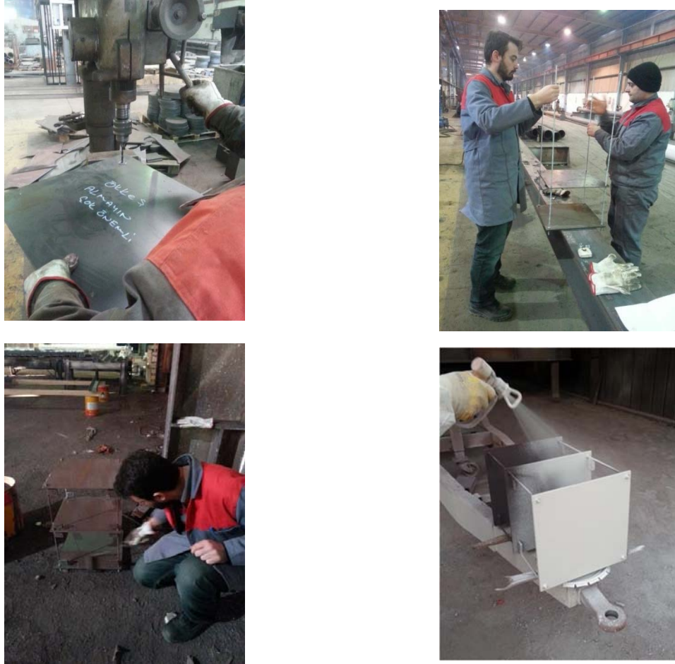
Şekil 4. 2 Katlı Çelik Yapı Modelinin Üretimi
