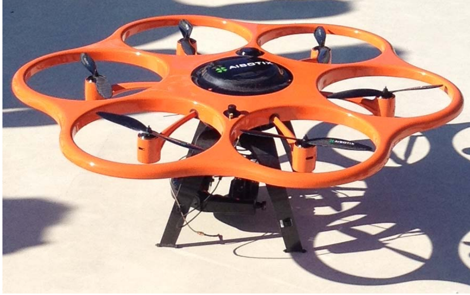
Şekil 1. Saha denemelerinde kullanılan Aibotix X6 6 rotorlu İHA
